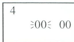
2. L'indicazione delle ore lampeggia. Impostare le ore per il cambio del giorno con i tasti + o -. Impostare di regola la mezzanotte (0:00)
