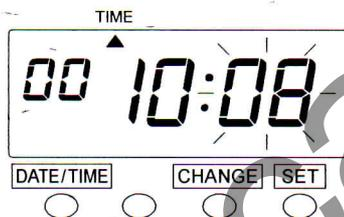
**3** Premere **CHANGE** impostare le ore. Nell'esempio le ore non devono essere cambiate. Premere **SET** per convalidare, sul display lampeggia l'indicazione dei minuti.
